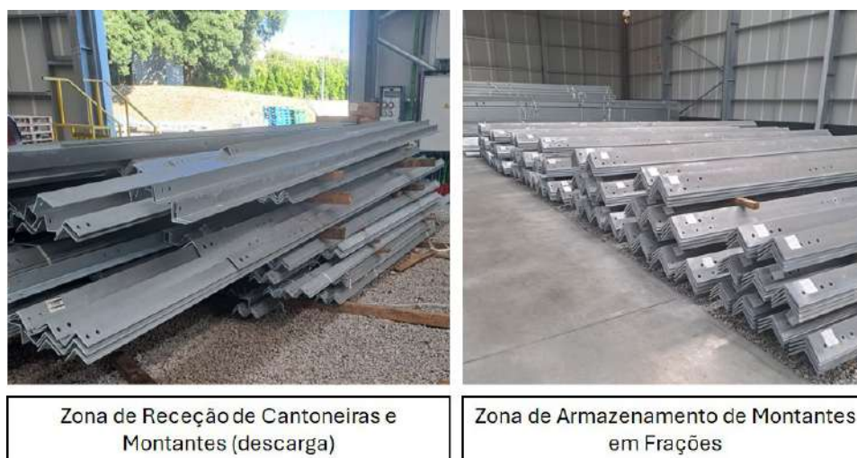
Figura 50 - Operações de receção, triagem, embalamento e armazenamento dos montantes no pavilhão logístico da MTG6.
