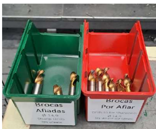
Figura 42 - Caixas de colocação de brocas aplicando a gestão visual: caixa verde para brocas afiadas e caixa vermelha para colocação de brocas por afiar.
