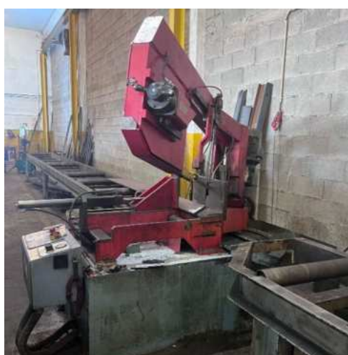
Figura 14 - Serra de corte com capacidade de 600 mm de largura.
