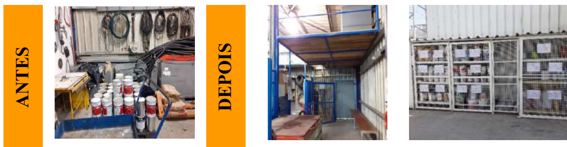
Figura 25. Comparação da situação antes e da situação depois da aplicação dos 5S na entrada do setor T1c, evidenciando a nova zona de armazenamento de produtos químicos no exterior.
