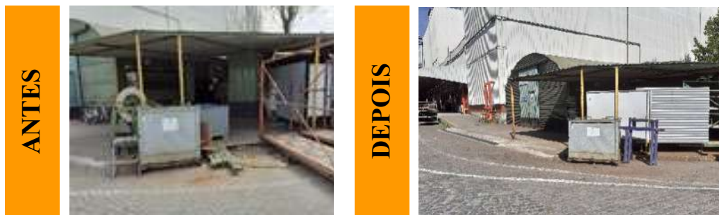
Figura 42. Comparação da situação antes e da situação depois da implementação dos 5S, relativa à zona da entrada/saída nos setores T5c e T6c.
