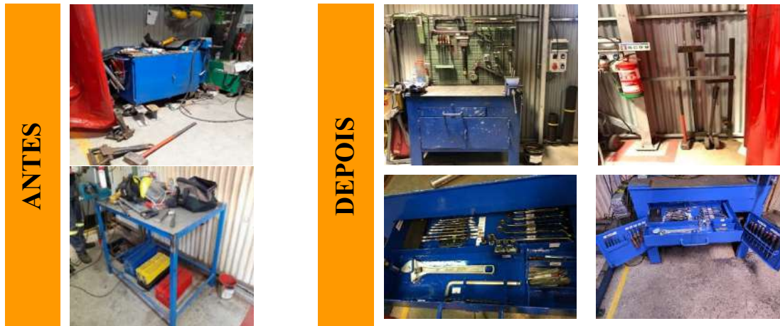
Figura 45. Comparação da situação antes e da situação depois da implementação dos 5S, relativa às bancadas de trabalho nos setores T5c e T6c.
