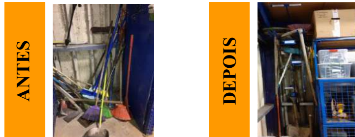
Figura 27. Comparação da situação antes e da situação depois da implementação dos 5S, relativa aos equipamentos de limpeza e construção civil no setor T1c.
