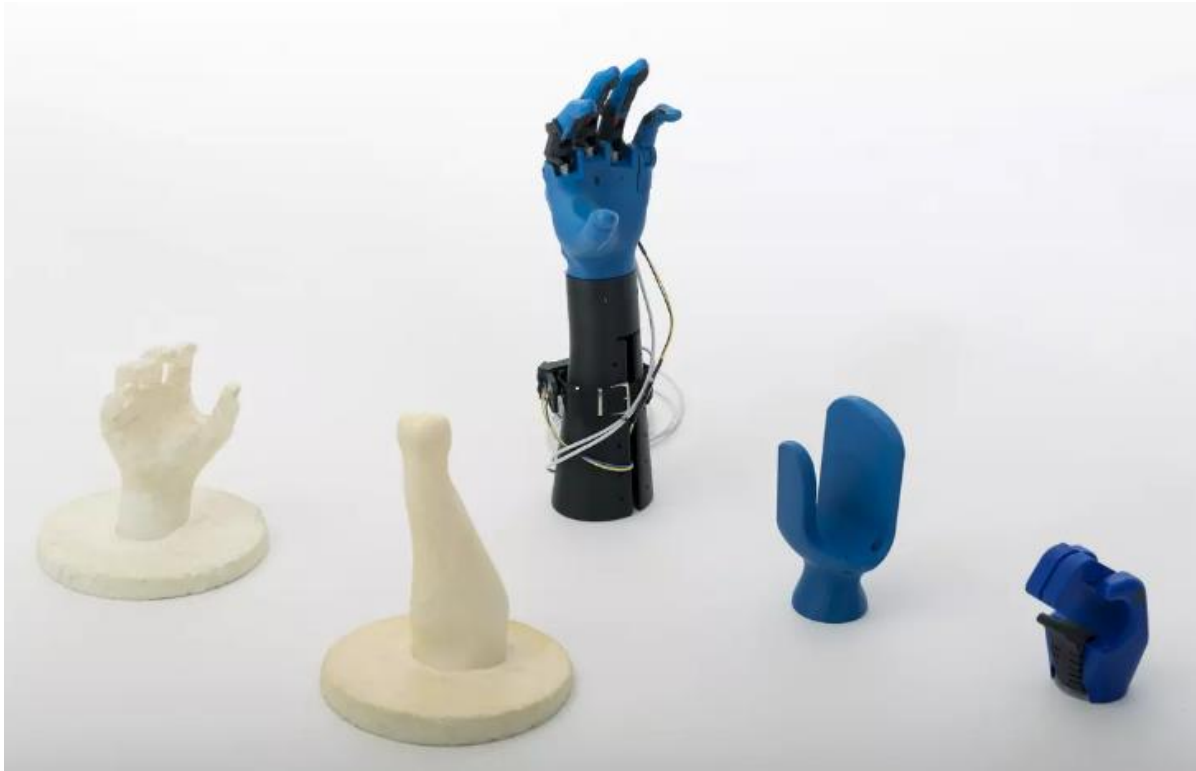
Figura 2 – Prótese de mão com módulos de custo reduzido, impressa em 3D para crianças, da Universidade de Engenharia da Suíça
