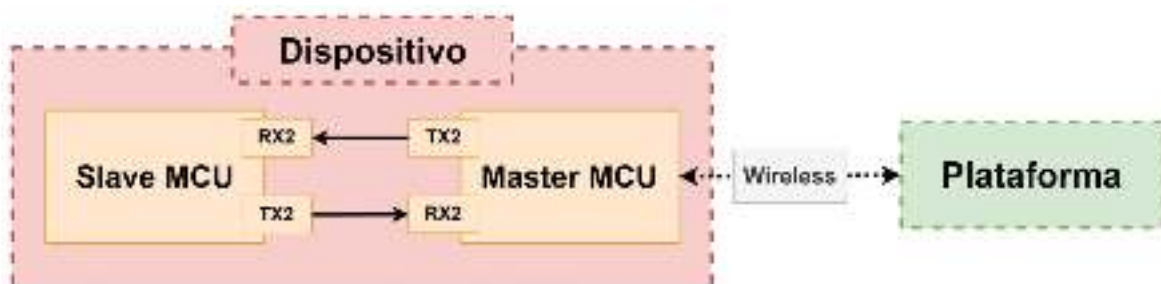
Figura 70 - Comunicação serial entre Master e Slave MCU
