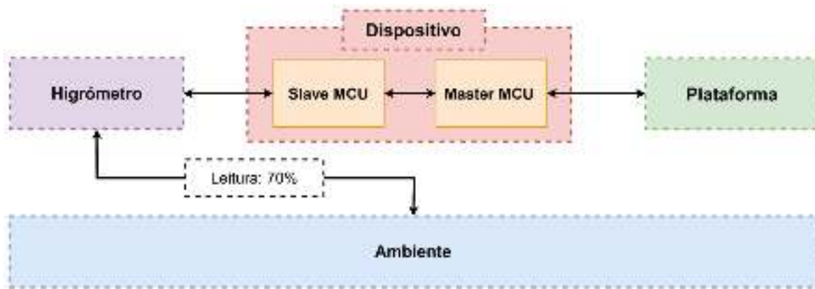
Figura 31 - Processo de comunicação do sistema
