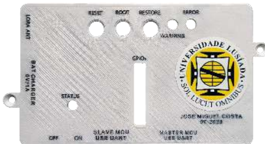
Figura 86 - Tampa do dispositivo com os respetivos códigos de identificação gravados a laser
