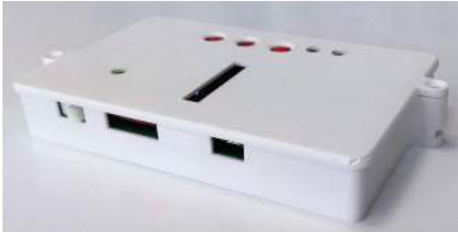
Figura 85 - Base (parte inferior) e tampa (parte superior) do chassi do dispositivo
