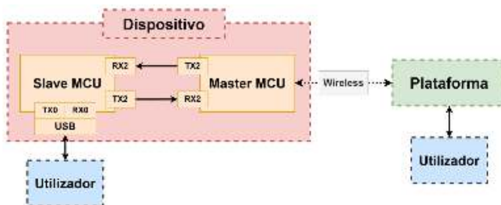
Figura 71 - A comunicação com utilizador tanto pode ocorrer por wireless (lado direito), como pelo barramento serial (lado esquerdo)
