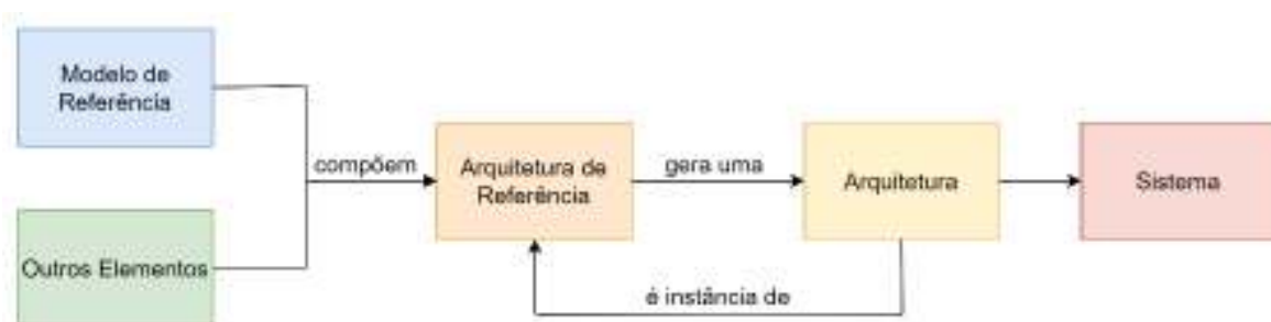
Figura 4 - Relação entre modelos de referência, arquiteturas de referência e arquiteturas (Adaptado de [27])
