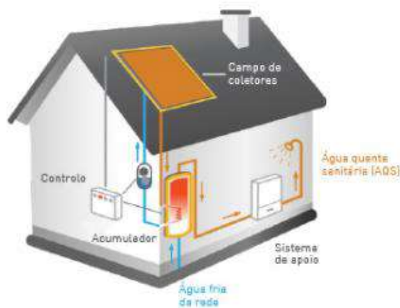
Figura 12 - Sistema de Circulação Forçada
