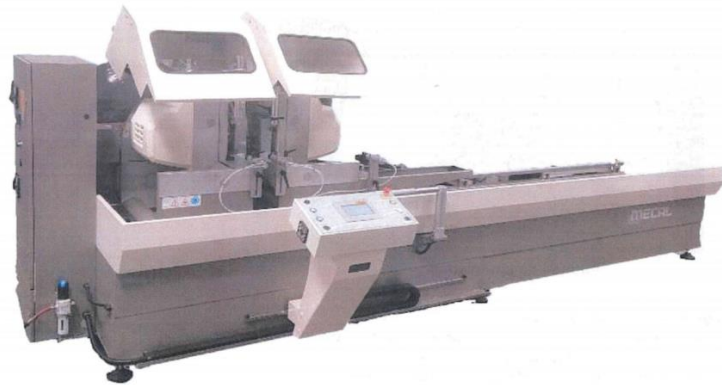
Figura 17: Máquina de corte de 2 cabeças para o processo de corte na GHP360.
