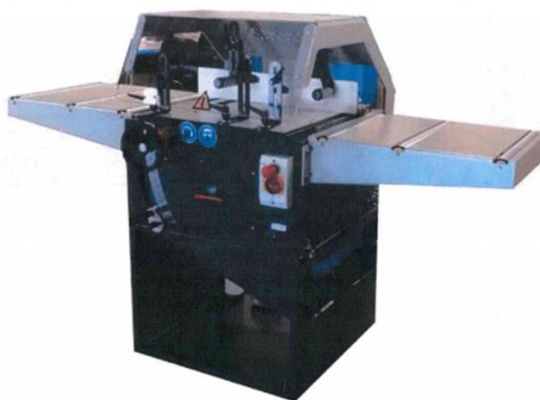
Figura 18: Serra de corte longitudinal para o processo de corte na GHP360.
