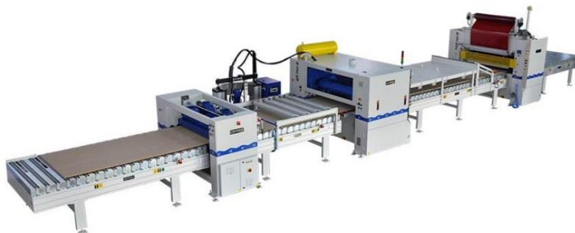
Figura 23: Máquina para o processo de colagem na GHP360.
