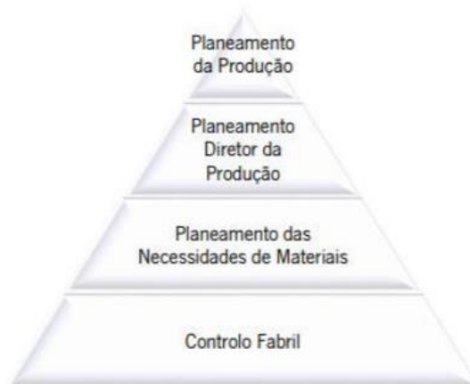
Figura 3 - Enquadramento do PCP considerando os diferentes níveis hierárquicos de uma empresa, desde a gestão de topo até ao chão-de-fabrica. Adaptado de Vaz (2019).
