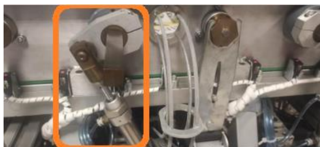
Figura 10 - Atuador que permite a rotação do eixo para efetuar o remate
