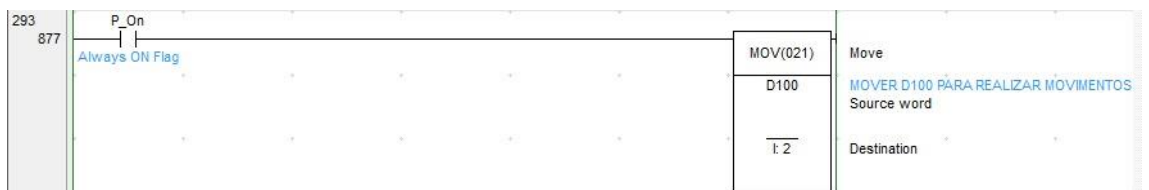
Figura 33 - MOV do D100 para a área onde se encontram saídas dos movimentos dos eixos
