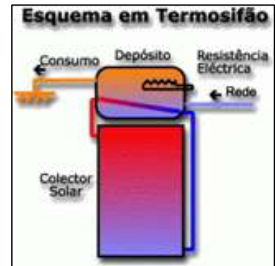
Figura 86 – Esquema ilustrativo de um sistema passivo – circulação em termosifão.
