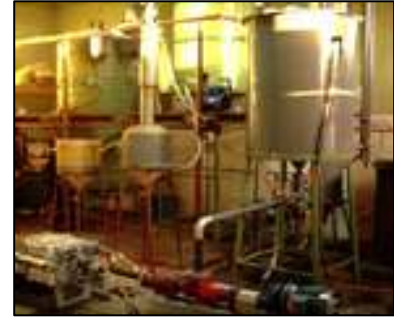
Figura 29 – Instalação para o tratamento de efluentes de descasque de sementes de alfarroba.
