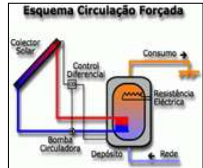
Figura 88 – Esquema ilustrativo de um sistema activo – circulação forçada.
