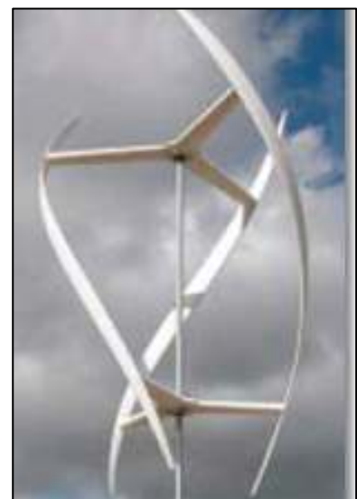
Figura 24 – Energia Eólica – sistema de eixo vertical.
