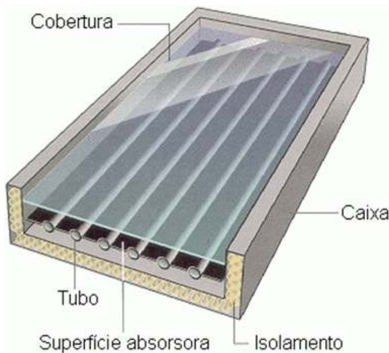
Figura 81 – Esquema ilustrativo de um colector plano com cobertura.
