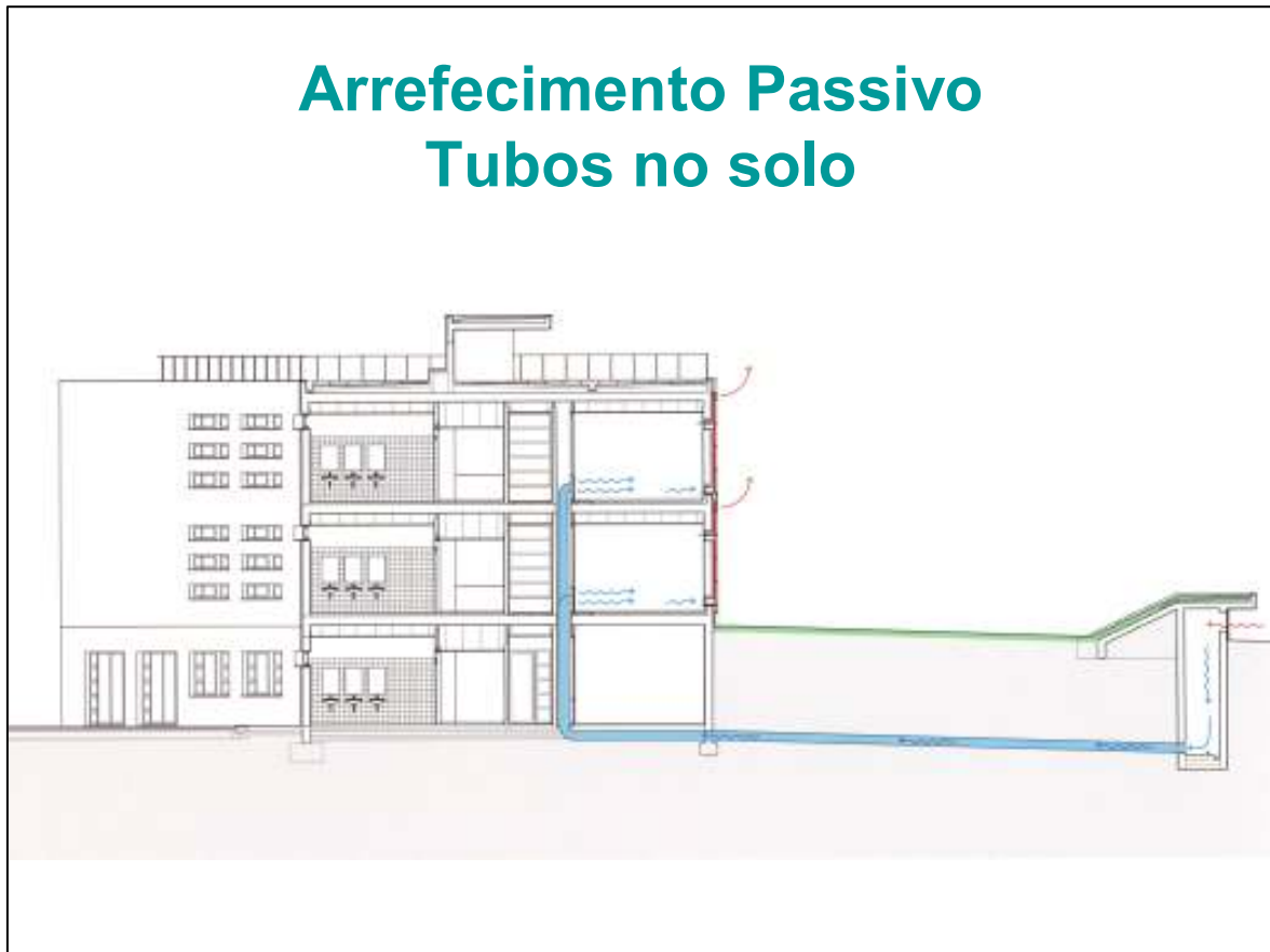
Figura 133 – Edifício Solar XXI do INETI – Arrefecimento Passivo pelo Solo; Corte esquemático do funcionamento do sistema de arrefecimento.
