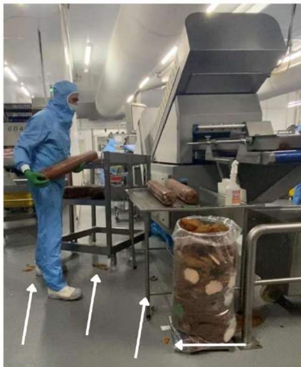
Figura 17- Colaborador a abastecer a máquina e há sujidade no solo
