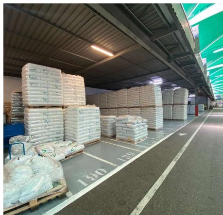
Figura 11 – MP armazenadas em bloco (Grupo Simoldes, 2022).
