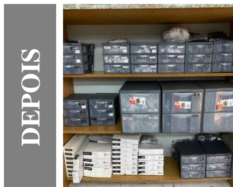
Figura 40 – Arrumação dos acessórios da confeção no setor P.1, após a aplicação dos 5S.
