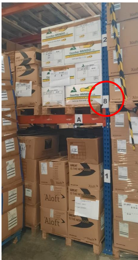
Figura 22 - Identificação inadequada de estante.
