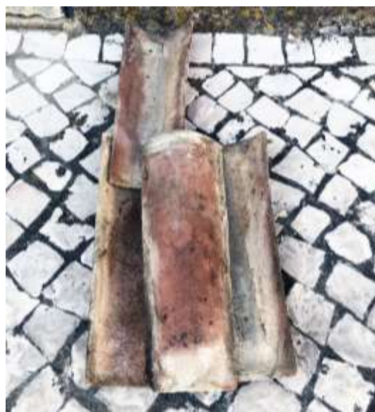
Ilustração 54 – Esquematização da disposição de telhas de canudo. (Ilustração nossa, 2021)
