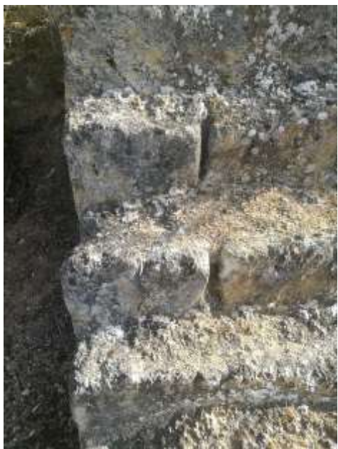
Ilustração 13 – Marcas de picareta numa bancada de extração em Pernes. (Ilustração nossa, 2021)
