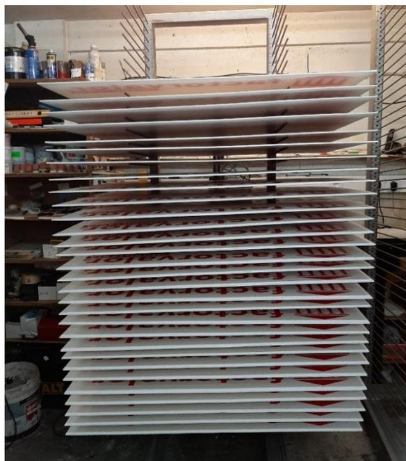
**Figura 26.** Estrutura metálica para secagem a temperatura ambiente.
