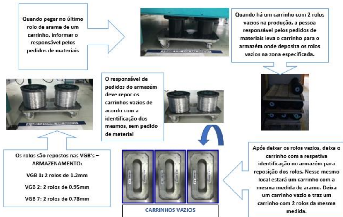
Figura 45 - Esquematização do pedido cíclico dos arames
