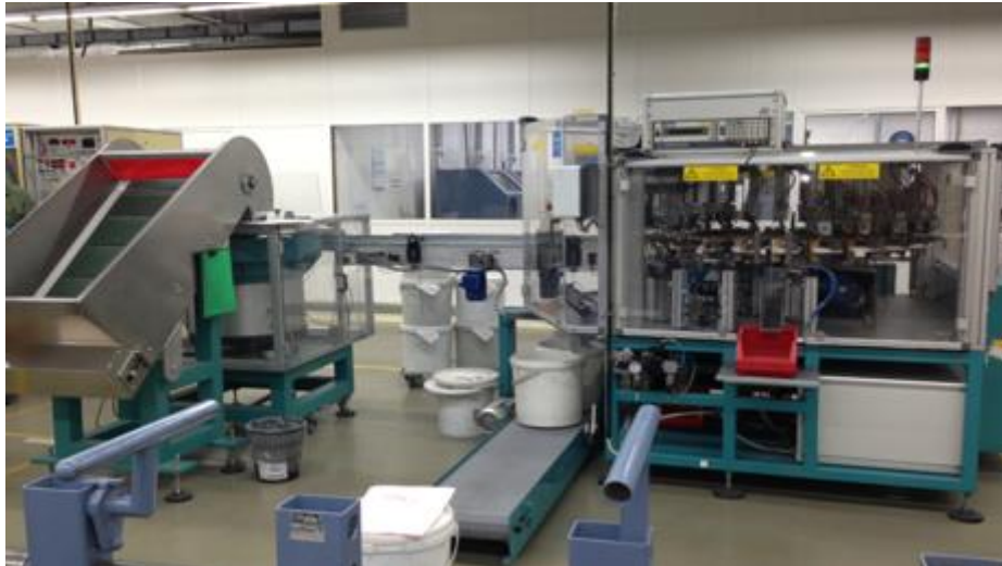
Figura 11 - Máquina de tratamento de tensão elétrica na Pré-Montagem
