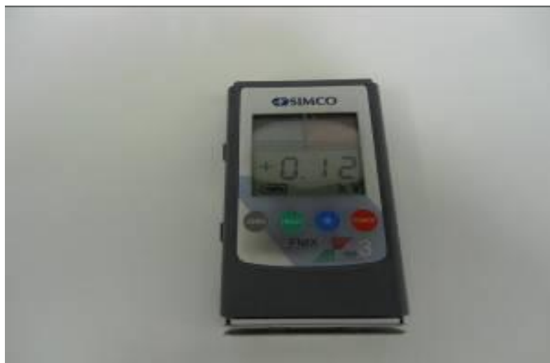
Figura 28: SIMCO – Medição Eletricidade Estática da Apoloblu
