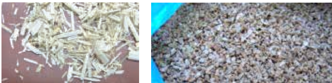
Ilustração 99 – À esquerda, fibras de cânhamo (caule), à direita, granulado de cortiça, exemplos de aglutinados usados no fabrico dos blocos de encaixe de baixo carbono. (Eires, Jalali e Camões, 2007, p. 3-4).
