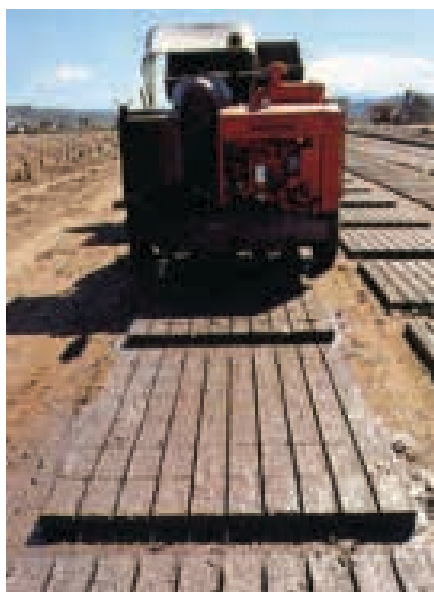
Ilustração 25 – Produção mecanizada de adobe no Novo México, E.U.A., J. Evrard. (Auroville Earth Institute, 2020).
