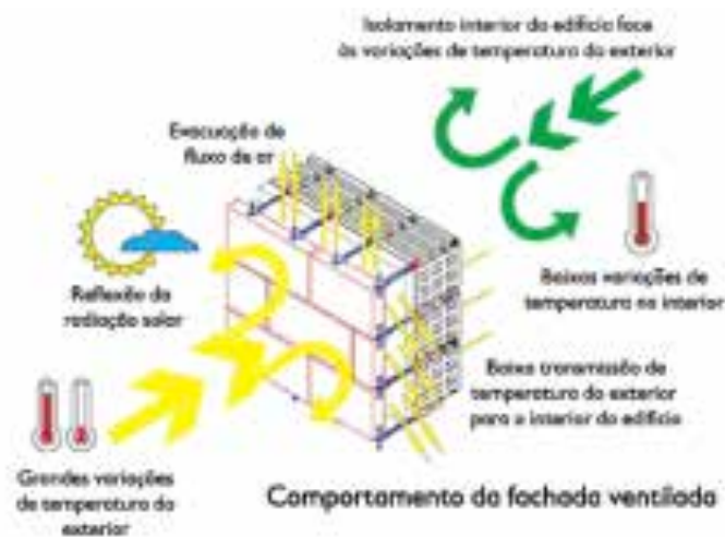
Ilustração 130 – Comportamento do sistema da parede ventilada. (Construlink, 2006, p. 3).
