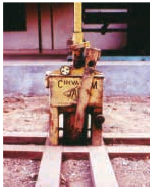
Ilustração 32 – A primeira prensa para blocos de terra comprimida da CINVA-Ram. (Auroville Earth Institute, 2020).
