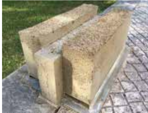
Ilustração 102 – Molde em chapa metálica e bloco de cal de baixo carbono. (Pinto, 2018, p. 220).
