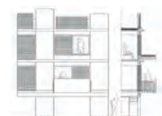
17. Representação da distribuição dos vãos e das janelas triplas de correr. (2017) p. 103.
