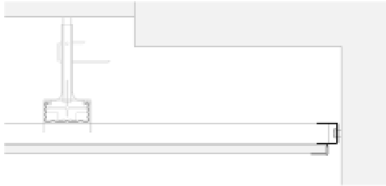
Ilustração 44 – Detalhe do perfil de remate do teto com a parede – excerto de peça desenhada. (Portugal, 2017).
