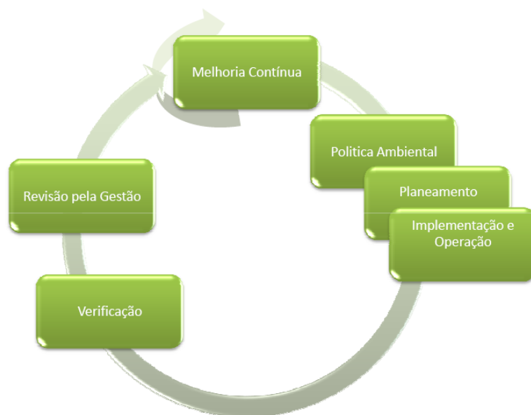
Figura 16: Modelo de um Sistema de Gestão Ambiental de acordo com a NP EN ISO 14001:2004
