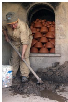
Fig.49 - Preparação do barro para encerrar a porta do forno
