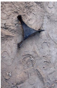
Fig.91 - Elemento utilizado para separa entre si as peças encasteladas dentro do forno
