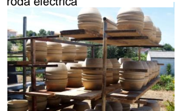
Fig.42 - Secagem das peças modeladas
