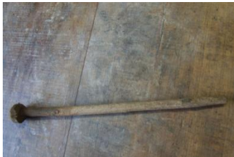
Fig.33 - Moca. Utilizada para peças com orifícios estreitos
