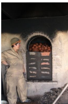
Fig.51 -Forno preparado para a 1ª fase de cozadura
