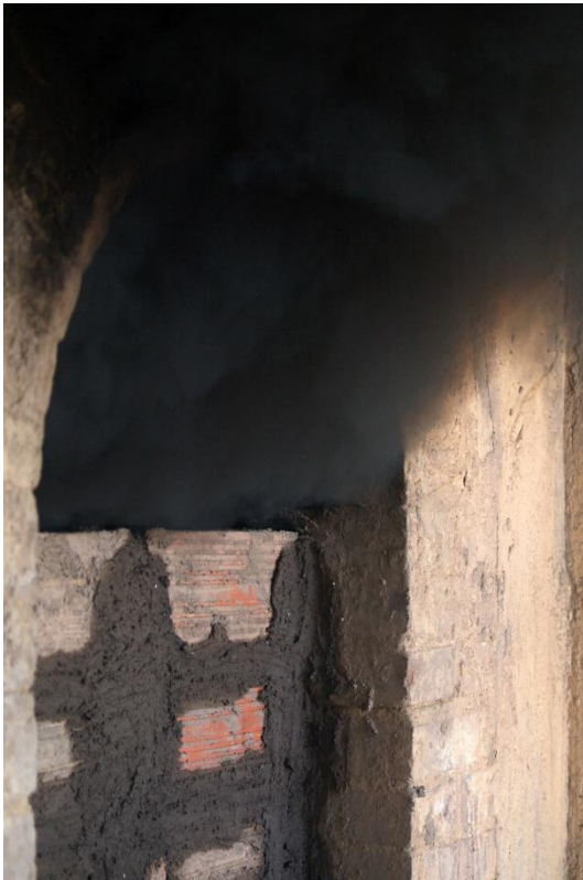
Fig.54 - Libertação de dióxido de carbono durante a alimentação da fornalha
