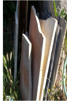
Fig.89 - Cerâmica refractária para utilizar no revestimento do pavimento do forno
