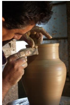
Fig.71 - Exemplificação da utilização do alisador na modelação
