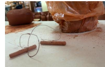
Fig.35 - Fio de nylon para retirar as peças da roda
