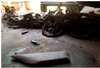
Fig.30 - Alisador para uniformizar a superfície das peças
