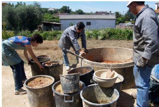
Fig.81 - Barro proveniente das barreiras armazenado até à sua utilização
