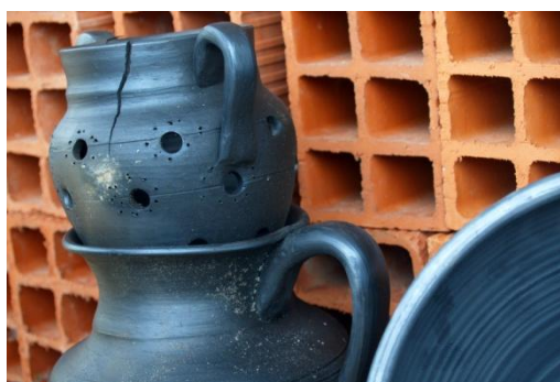
Fig.68 - Louça estalada durante a cozedura. Não é recuperável.
