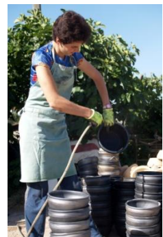
Fig.93 - Eliminação de cinzas recorrendo a um compressor de ar
