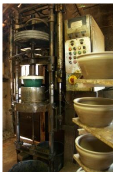
Fig.74 - Máquina de modelação dos caçoilos
