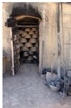
Fig.84 - Forno carregado para iniciar a cozedura
