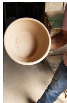
Fig.85 - Louça rachada durante a secagem
