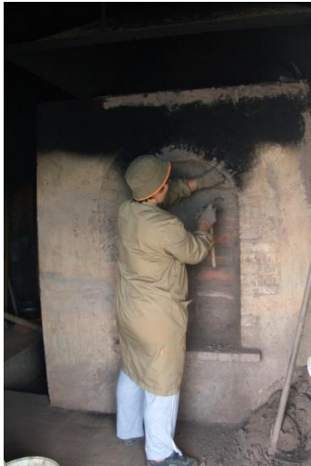
Fig.61 - Abertura do forno após 24h da cozedura
