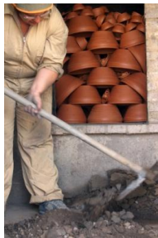
Fig.48 - Fase de encerramento da porta do forno
