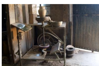
Fig.41 - Roda eléctrica da olaria do mestre Fernando
