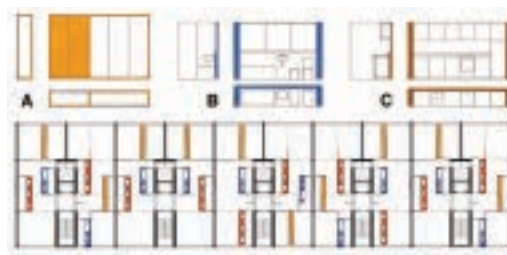
Ilustração 61 – Sistema “ABC”: possíveis combinações e disposições dos núcleos de serviços. (Gausa, 1998, p. 26)
