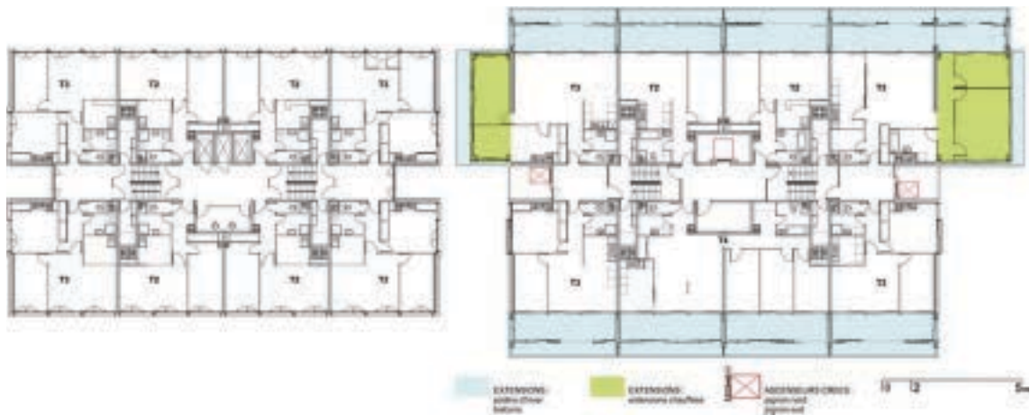
Ilustração 213 – Plantas de um piso-tipo de apartamentos existente (à esquerda) e após a transformação (à direita). (Lacaton & Vassal, 2015, p. 225)
