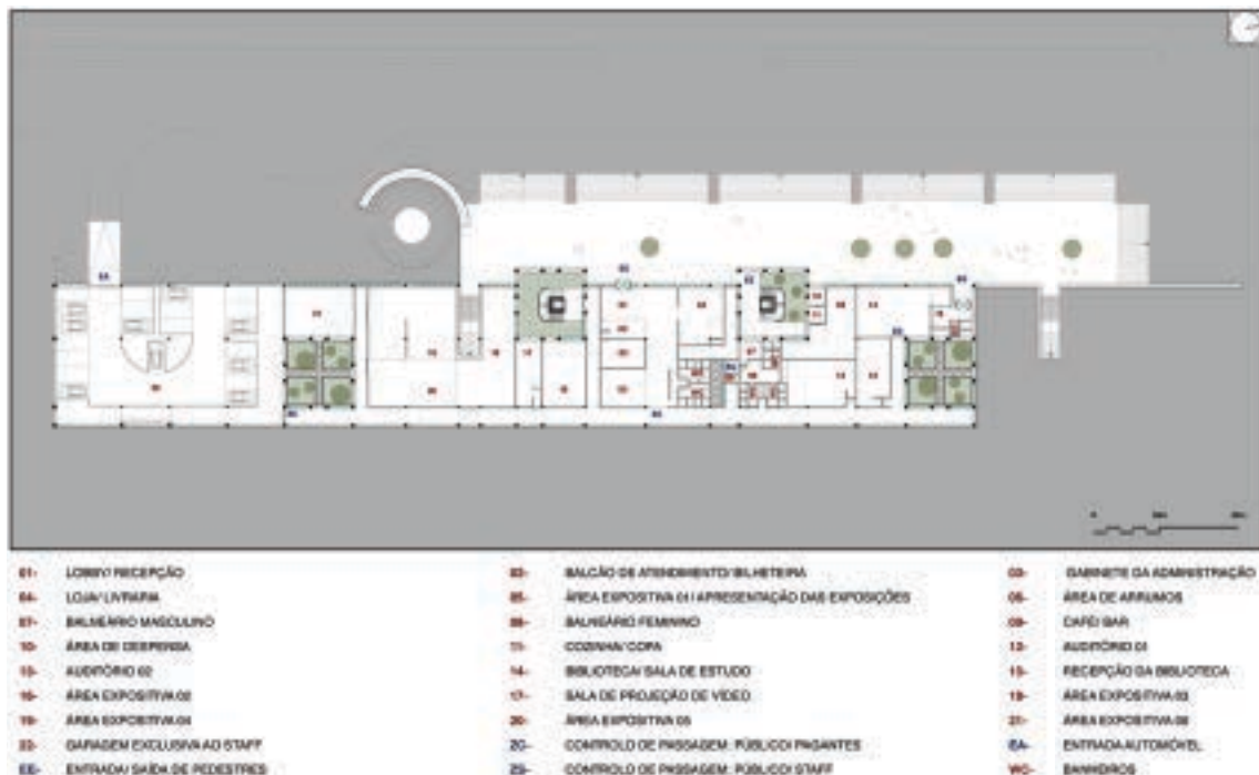
Ilustração 201 – Planta do piso térreo da 2ª fase da proposta de intervenção (museu e espaço multifuncional). (Ilustração nossa)
