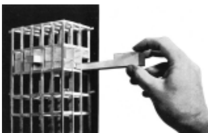
Ilustração 81 – “Unité d’Habitation” (1947-1952) esquema estrutural e de composição das unidades habitacionais. (Archivo de Imágenes Digitales, s.d.)
