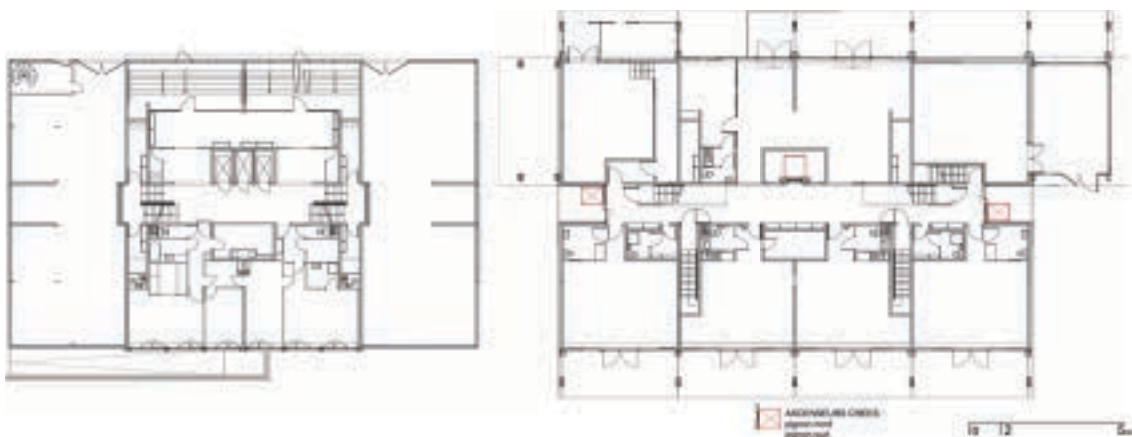
Ilustração 212 – Plantas do piso térreo existente (à esquerda) e do piso térreo após a transformação (à direita). (Lacaton & Vassal, 2015, p. 225)
