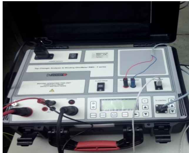
Figura 52: Equipamento de medição da resistência dos enrolamentos do T.P. e do RTEC [EDP].
