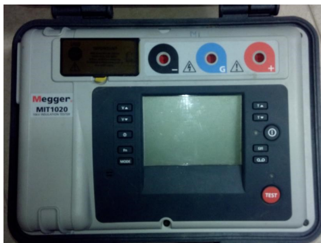
Figura 58: Mega ohmímetro para medição da resistência de isolamento [EDP].
