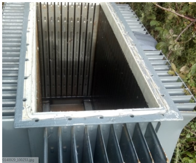
Figura 13: Cuba de um transformador 630 kVA [EDP].
