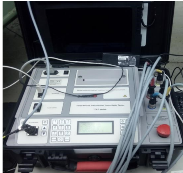
Figura 54: Equipamento utilizado na monitorização da razão de transformação [EDP]
