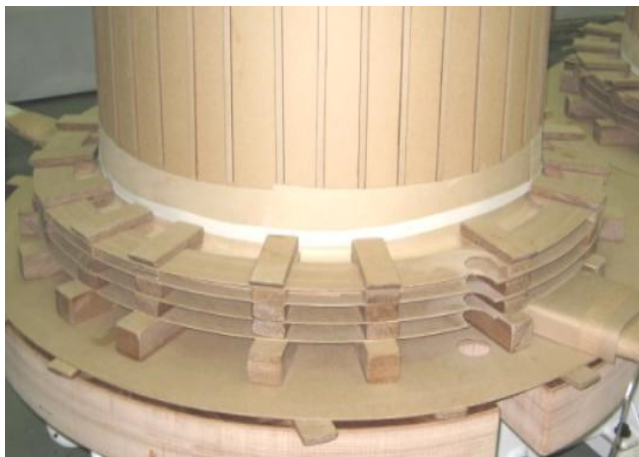
Figura 20: Calços e isolamento [31].
