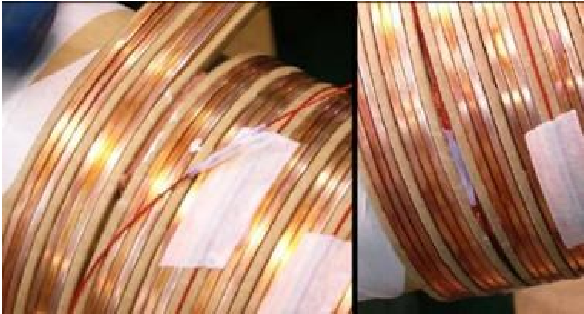
Figura 66: Sensor de fibra óptica instalado nos enrolamentos [81].
