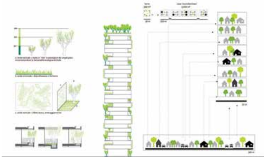
Ilustração 68 – Esquema ilustrativo da disposição da vegetação para otimizar o sombreamento e esquema de comparação da ocupação do solo. (Fonte:(Boeri, 2014)
