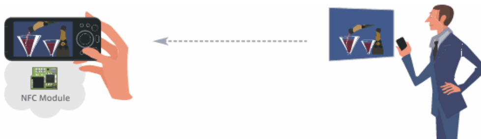
Ilustração 5 - Transmissão de dados através de dispositivos NFC – Card Emulation Mode (NFC World, 2013 - http://www.nfcworldcongress.com/ )
