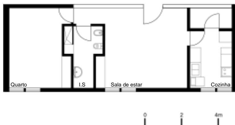
Ilustração 124 – Planta tipo das habitações simplex. (Ilustração nossa, 2016)
