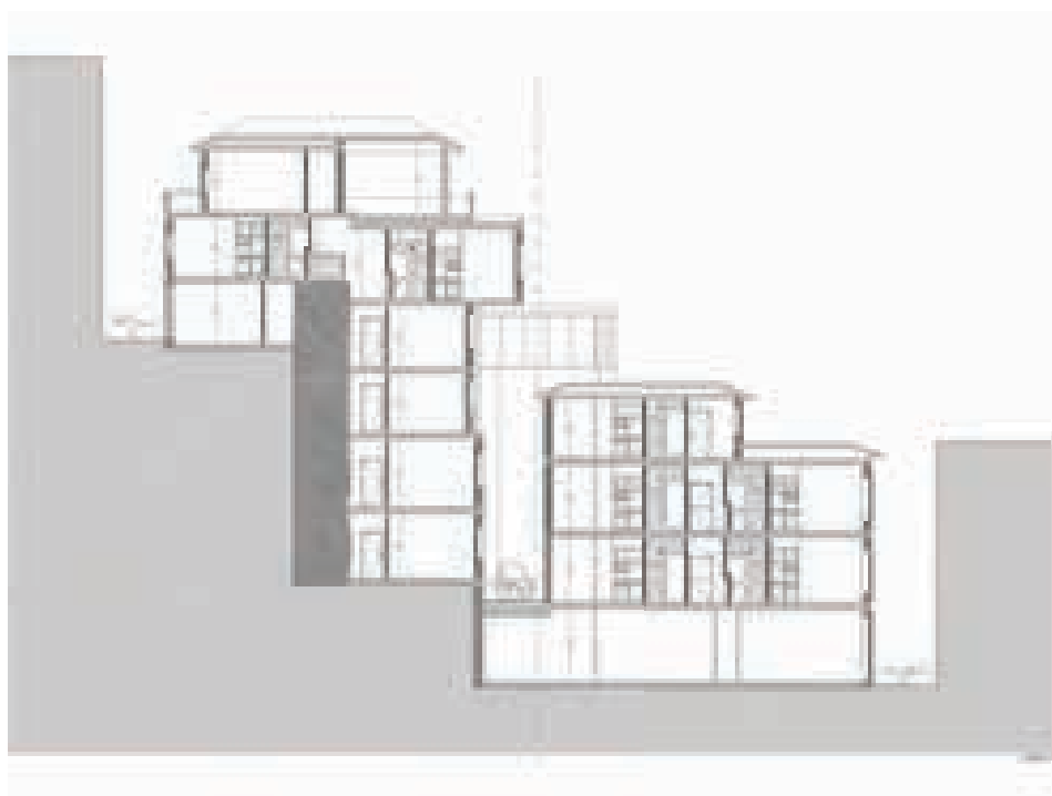
Ilustração 75 - Corte – Residência de Estudantes (PORTO VIVO, SRU, 2015)
