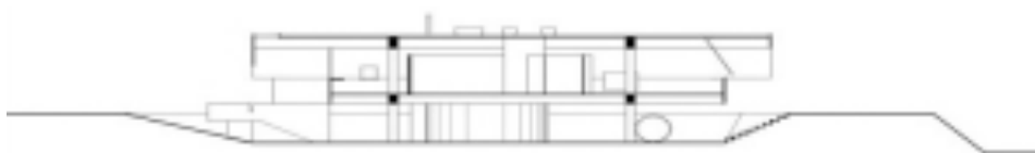
Ilustração 59 - Corte Longitudinal das Casas Gêmeas (São Paulo, Brasil), projeto do Arqt. Paulo Mendes da Rocha. (Igor Fracalossi, 2014)
