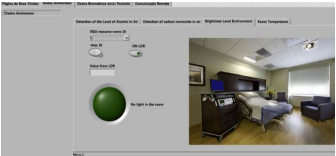
Figura 96: Interface em Labview do MCT para o nível de luminosidade no quarto
