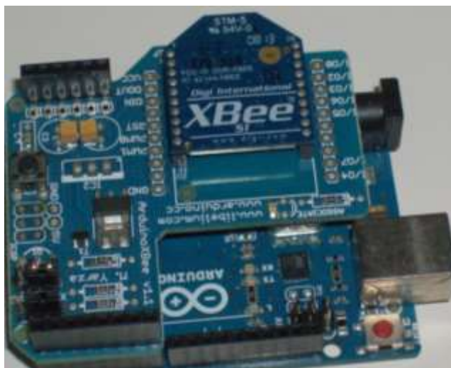
Figura 43: XBee colocado sobre o XBee shield a ser colocado por cima do Arduino.
