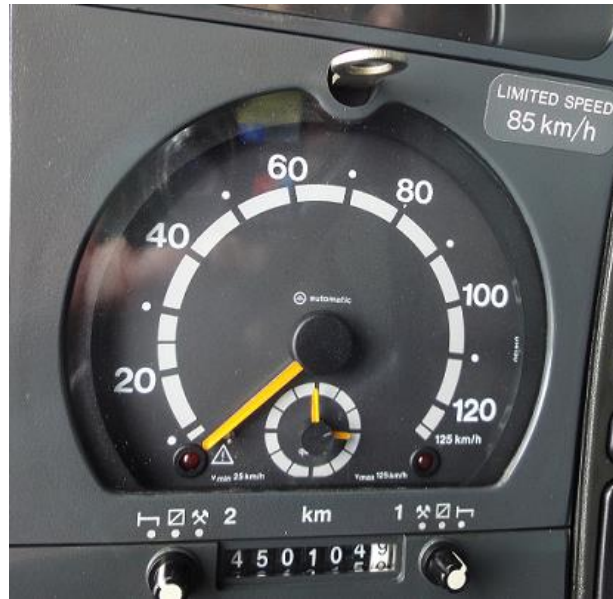
Ilustração 2 - Painel do tacógrafo analógico. (Ilustração nossa)
