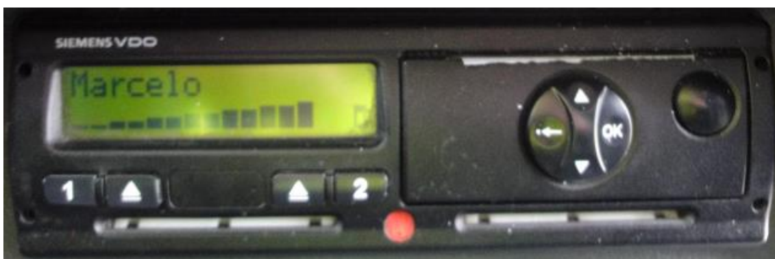
Ilustração 9 - Painel do tacógrafo digital, imediatamente após a introdução do cartão, no momento em que o aparelho se encontra a transferir dados do e para o cartão tacográfico. (Ilustração nossa)
