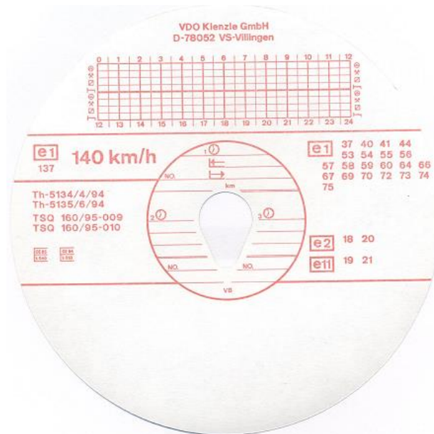
Ilustração 4 - Folha de diagrama, de registo ou disco (verso). (Ilustração nossa)
