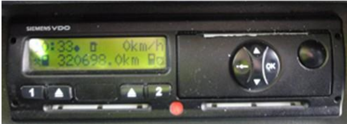
Ilustração 8 - Painel do tacógrafo digital. (Ilustração nossa)
